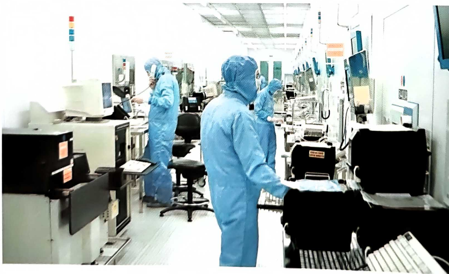
In der Fertigungshalle von ALTIS werden in 25.000m 2 partikelfreier Umgebung 42.000 200 mm-Platinen im Monat produziert.
